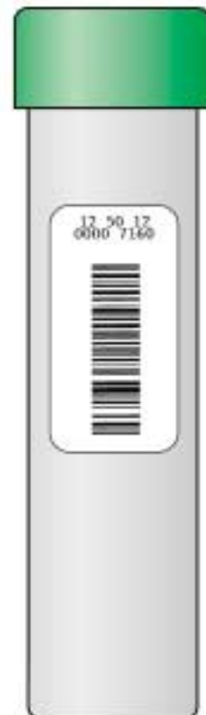
Strekkoder må ikke klæbes rundt om glasset, men skal påsættes lodret på prøvebeholderen, så de kan læses med strekkodelæser
